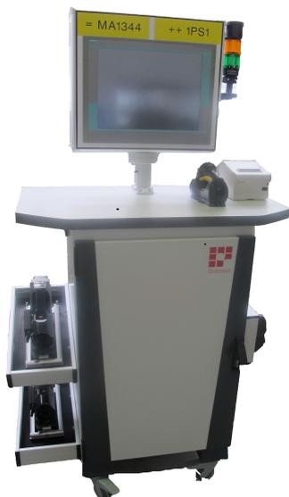
Im klimatisierten Schaltschrank befindet sich ein Industrie – PC, Netzteile und Sicherungen. Darauf die Arbeitsplatte, auf der ein Belegdrucker, das Ladegerät, eine Minitastatur und andere Tools, wie Barcode Leser Platz finden.
